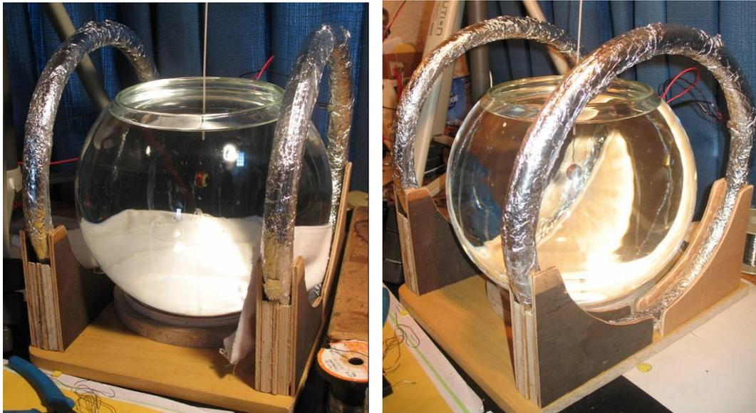
En théorie, les deux bobines doivent être séparées de leur rayon. Ici, leur diamètre est de 26 centimètres. Elles sont séparées de 19 centimètres pour recevoir le bocal entre elles. Les bobines sont blindées avec du papier métallique non fermé et mis à la masse pour bloquer les couplages capacitifs entre bobines et milieu aqueux.
