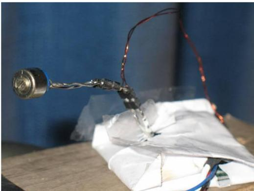
Sur la photo, il est recouvert d'un film conducteur relié à la masse électrique pour le protéger de couplages capacitifs, comme le sont les bobines excitatrices.
