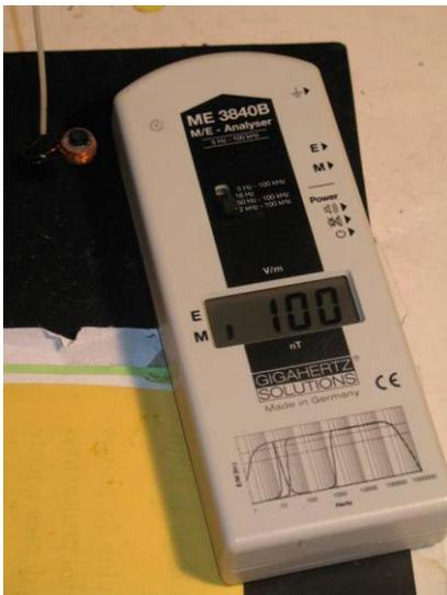
Etalonnage du champ magnétique à  $\pm 100$  nano teslas à 100 kHz au centre avec le ME2830 B GIGAHERTZ SOLUTIONS à côté du capteur bobine.
