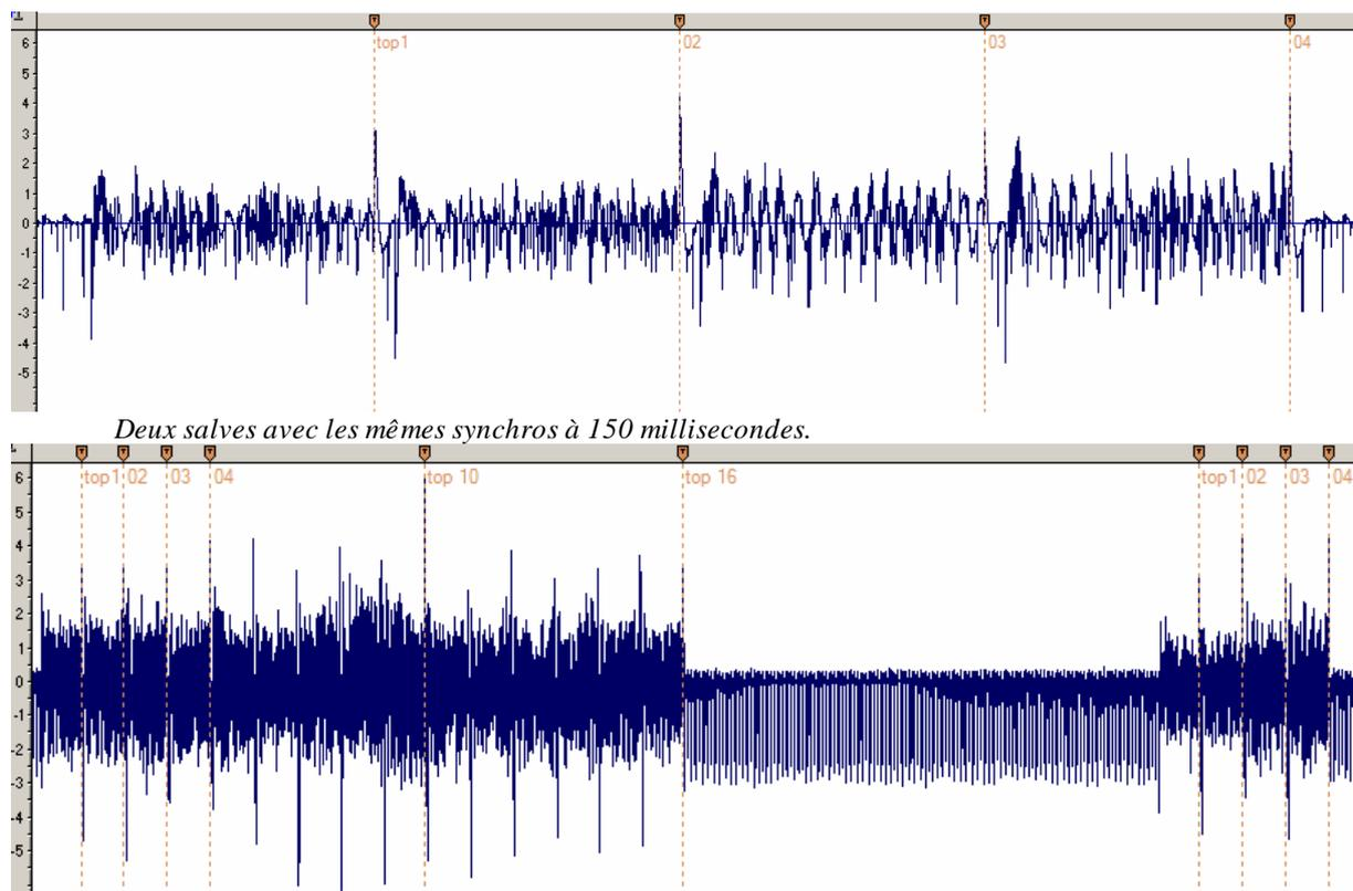
Le fait d'identifier les tops synchros au même rythme précisément dans le courant pulsé linky de l'appartement et dans le signal audio démodulé par le poste grandes ondes dans la rue, prouve que nous avons bien à faire à un signal du protocole linky.
