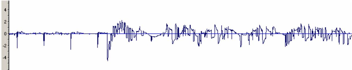
Ci-dessus, sur toute la durée d'une salve linky commençant après les parasites réguliers du 50 Hz constatés, la fréquence à 70 KHz est émise à des amplitudes, dont ici seulement leur hauteur est enregistrée. Comme l'enregistrement ne passe pas le continu, c'est le premier front d'attaque de la salve qui donne l'amplitude du courant 0-crête.
