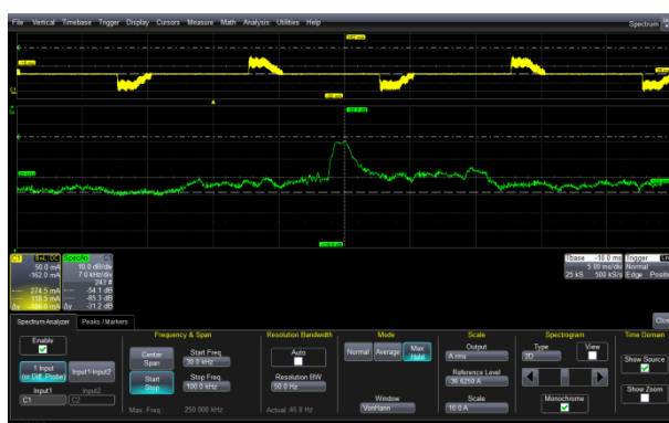
Figure 5-7: courant électrique (en haut) et spectre dans la bande 30 kHz – 95 kHz (en bas) Câble branché sur une lampe LED de 3W
