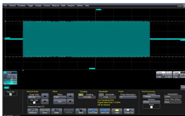
Figure 3-7: mesure de tension en sortie du compteur G1 : visualisation d'une trame (à gauche) et du spectre dans la bande de fréquences CPL Linky (à droite)
