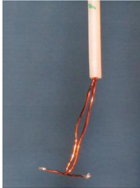
Elle peut être placée à tout endroit dans la sphère de liquide grâce au trépied gradué extérieur au bocal. La bobine de relevés de champ magnétique immergée est déplaçable de la même façon dans le volume du liquide.
