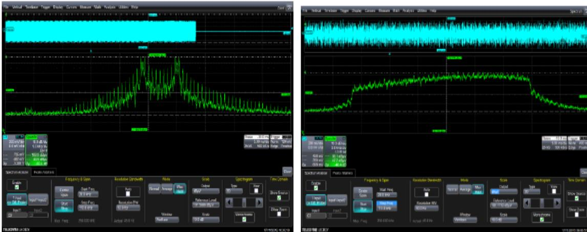
Figure 3-7 et 3-8 (p15 et 16) : spectres des CPL G1 et G3 Linky dans la bande de fréquences CPL
