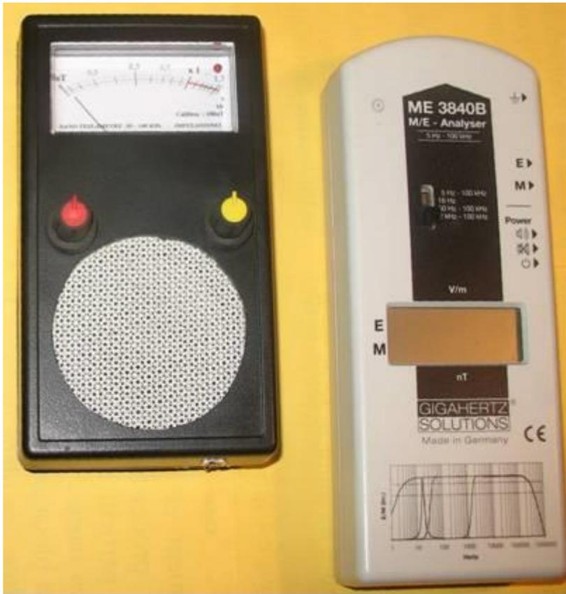
L'appareil de "référence" du commerce utilisé pour l'étalonnage du « nanoteslamètre » est le **ME 3840 B**, de la marque réputée **GIGAHERTZ SOLUTIONS**. Cet appareil ne comporte pas de démodulateur audio du champ mesuré.
